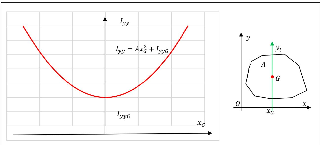
che mostra come il momento d'inerzia  $I_{yy}$  raggiunge il suo minimo quando è calcolato rispetto ad un asse baricentrico e che il suo valore cresce come una parabola in funzione della distanza  $x_G$  dell'asse del sistema di riferimento dal baricentro della sezione.
