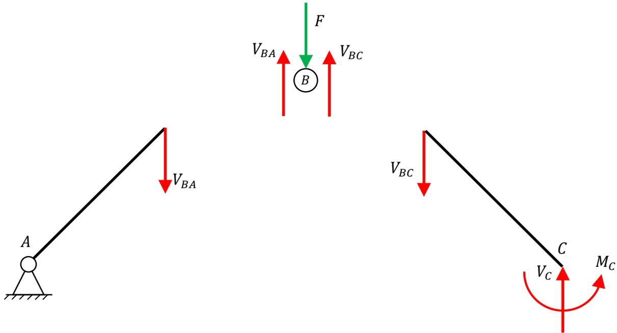
Osservando l'asta AB, vediamo che per l'equilibrio alla rotazione deve valere:  $V_{BA} = 0$ . Tornando alla cerniera B osserviamo che  $V_{BC} = F$ .
