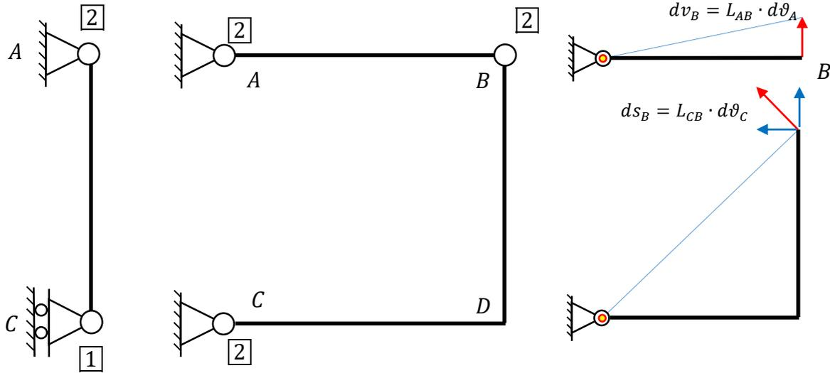
Struttura isostatica non labile
