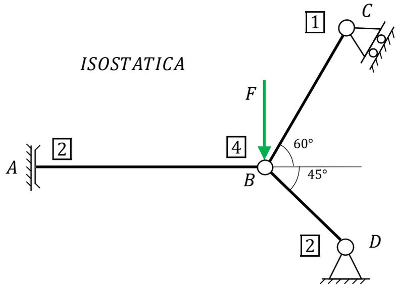
Si elimina il carrello nel nodo C e si sostituiscono le reazioni incognite
