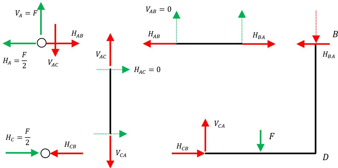
Osserviamo che le aste AC e AB sono rettilinee, uniscono 2 cerniere e non sono caricate: di conseguenza si tratta di **bielle scariche** che possono sopportare solo forze di trazione o di compressione.
