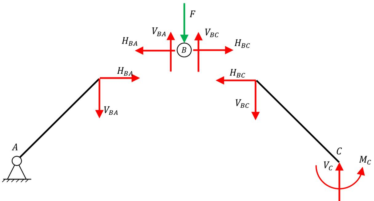
Osservando l'asta BC si ricava che  $H_{BC} = 0$  (unica forza orizzontale); passando al nodo B si osserva che  $H_{BA} = 0$ . Si ottiene:
