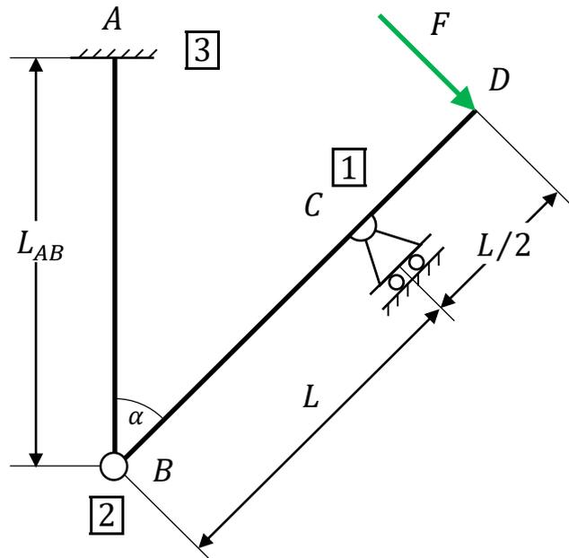
a) Si elimina la cerniera in B e il carrello in C
