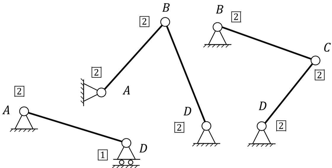
Scomposizione in tre strutture isostatiche non labili.
