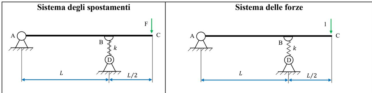
Poiché si chiede l'abbassamento del punto C dove è applicata la forza verticale  $F$  che agisce sulla struttura reale, la struttura delle forze è identica a quella degli spostamenti: le reazioni vincolari e le azioni interne saranno identiche, a parte il valore della forza applicata che dovrà essere unitaria.
