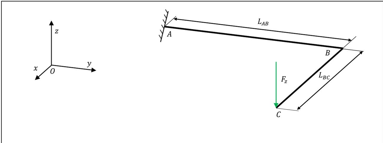
La sezione trasversale della trave è **circolare** di raggio R costante. Inoltre il materiale è omogeneo ed isotropo.
