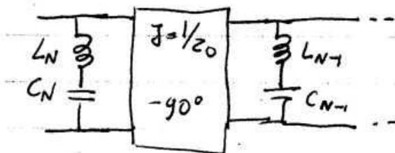
ovvero un filtro elmina-banda (che lascia passare banda uscente SWB in corto circuito).
