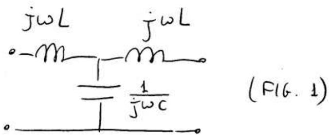
Ad alte frequenze le reti LC non sono utilizzabili, occorre realizzarle tramite linee di trasmissione:
