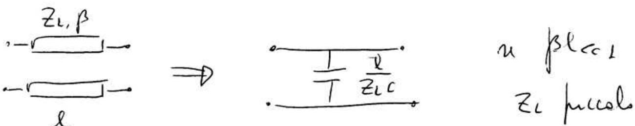
La precisione del filtro aumenta al crescere di  $Z_H/Z_L$  e quando questo rapporto è molto più grande possibile compatibilmente con i limiti tecnologici (un MS 10-180 Ω)
