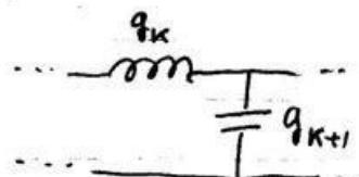
E' possibile ottenere prototipi diversi, in cui tutti i circuiti LC siano in parallelo (o in serie) utilizzando opportuni circuiti detti invertitori di ammettenza
