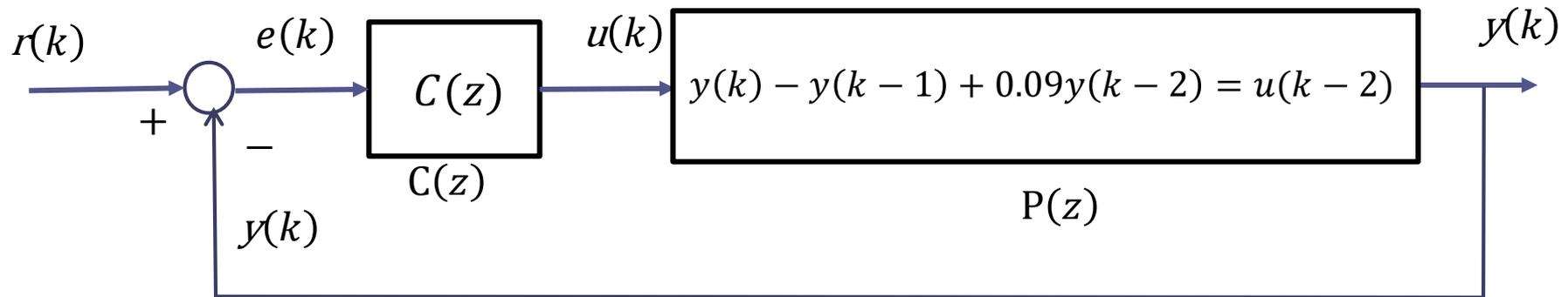
Si progetti, se possibile, un controllore digitale  $C(z)$  in grado di garantire per il sistema a ciclo chiuso uno fra i seguente legami fra il riferimento  $r(k)$  e l'uscita  $y(k)$ :
