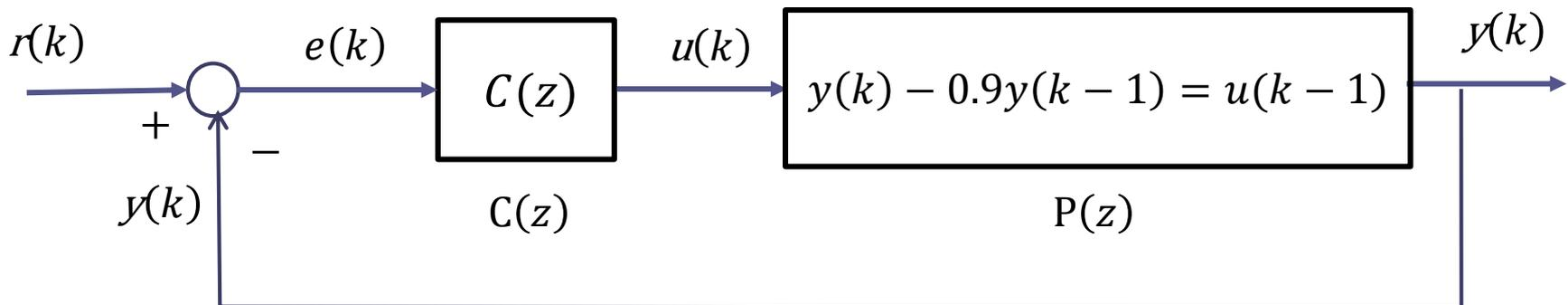
**Quesito 1.** Si progetti, se possibile, un controllore digitale  $C(z)$  in grado di garantire per il sistema a ciclo chiuso un legame istantaneo fra l'uscita ed il riferimento del tipo
