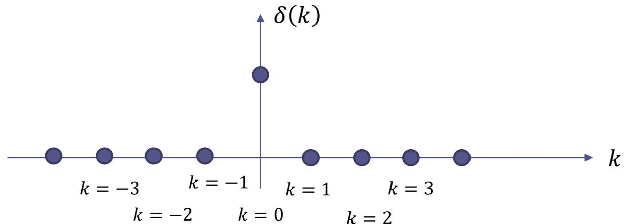
Le sequenze  $\delta(k + 1)$ ,  $\delta(k + 2)$ , ...,  $\delta(k + n)$  si ottengono «traslando» verso sinistra di 1, 2 o  $n$  passi la sequenza di base
