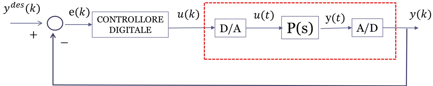
*Sistema di controllo digitale **in retroazione sull'uscita**, in cui il processo da controllare è espresso attraverso la sua Funzione di trasferimento  $P(s)$*
