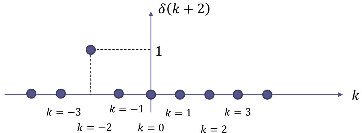
Analogamente, le sequenze  $\delta(k - 1)$ ,  $\delta(k - 2)$ , ...,  $\delta(k - n)$  si ottengono «traslando» verso destra di 1, 2 o  $n$  passi la sequenza di base
