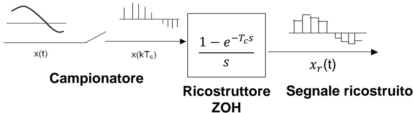
È evidente come la caratterizzazione dello ZOH mediante la funzione di trasferimento  $G_{ZOH}(s)$  sia valida anche se il segnale  $x(kT_c)$  in ingresso al blocco ricostruttore non viene ottenuto dal campionamento di un segnale a tempo continuo, ma è un segnale a tempo discreto  $x(k)$  prodotto, ad esempio, da un microprocessore che elabora un algoritmo di controllo.
