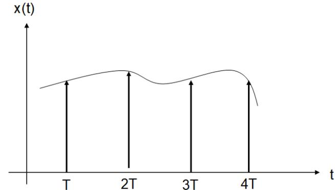
Il segnale  $x^*(t)$  può essere costruito moltiplicando il segnale  $x(t)$  per un treno di impulsi equidistanti, con spaziatura  $T_c$
