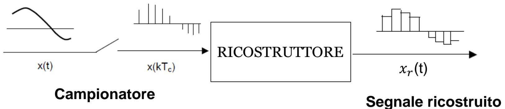
In generale, si può pensare di progettare il blocco ricostruttore in modo che effettui un'interpolazione polinomiale (di ordine  $n$  arbitrario) fra due campioni adiacenti. In questo caso si parla di ricostruttore di ordine  $n$ .
