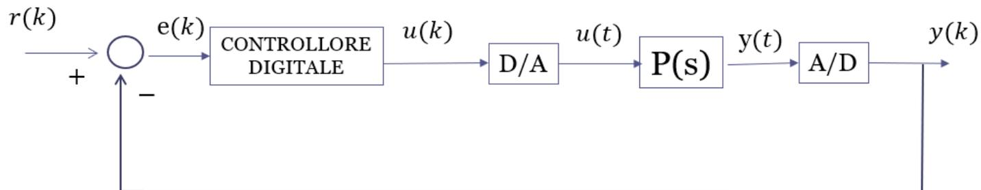
Analizzeremo nel contempo le caratteristiche spettrali dei segnali campionati e dei segnali «ricostruiti» per mezzo di conversione D/A di sequenze numeriche, onde ricavare utili indicazioni in merito ai criteri da adottare per scegliere il periodo di campionamento in un sistema di controllo digitale.
