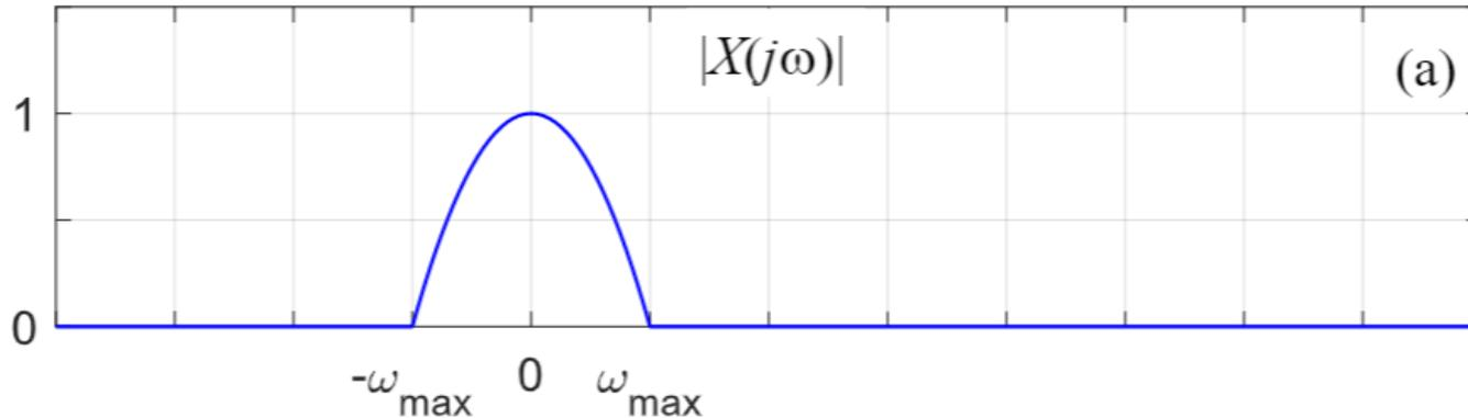
la particolare scelta del periodo di campionamento  $T_c$  (o della grandezza equivalente  $\omega_c = 2\pi/T_c$ ) conduce a diverse situazioni in merito al fatto che le «repliche» interferiscano fra loro o no.
