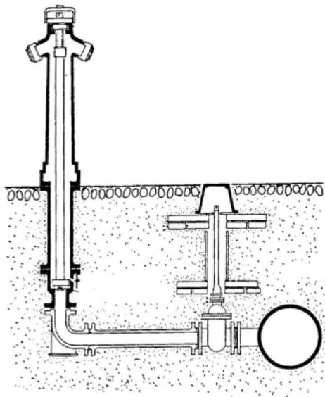
**Fig. 11.36** Esempio di idrante a colonna (soprasuolo).
