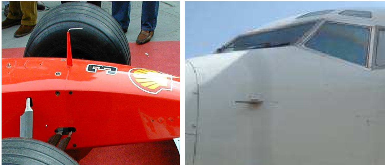
Figura 4: esempi di utilizzo del tubo di Pitot per la misura della velocità in una macchina da corsa (a sinistra) e in un aereo a destra)
