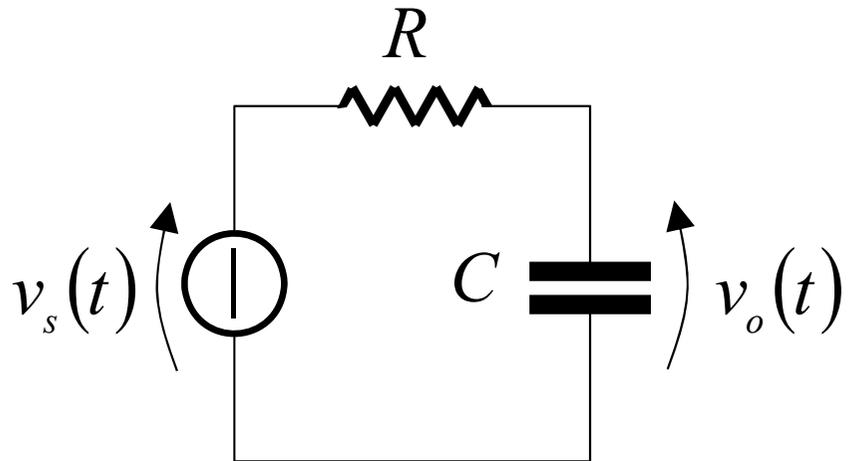
Per il circuito RC di figura, ricavare la funzione di trasferimento  $v_o/v_s$  e la sua risposta in frequenza.
