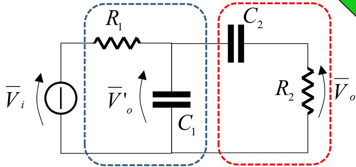
Possiamo determinare la funzione di trasferimento moltiplicando la funzione di trasferimento dei due filtri in cascata.
