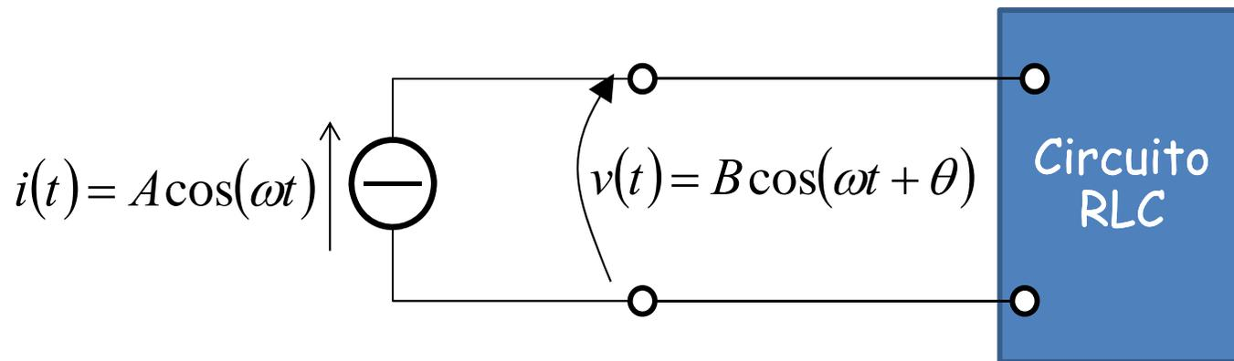
Funzione di rete  $\dot{H}(\omega) = \frac{\bar{V}}{\bar{I}} = \dot{Z}(\omega) = R(\omega) + jX(\omega)$
