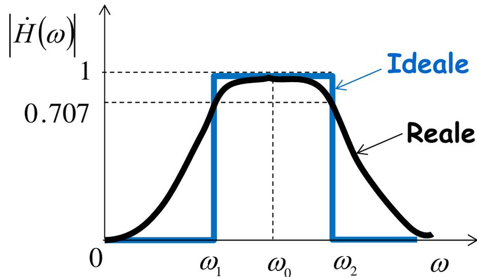
Un **filtro passa-banda** è progettato per lasciar passare tutte le frequenze contenute all'interno di una banda di frequenze,  $\omega_1 < \omega < \omega_2$
