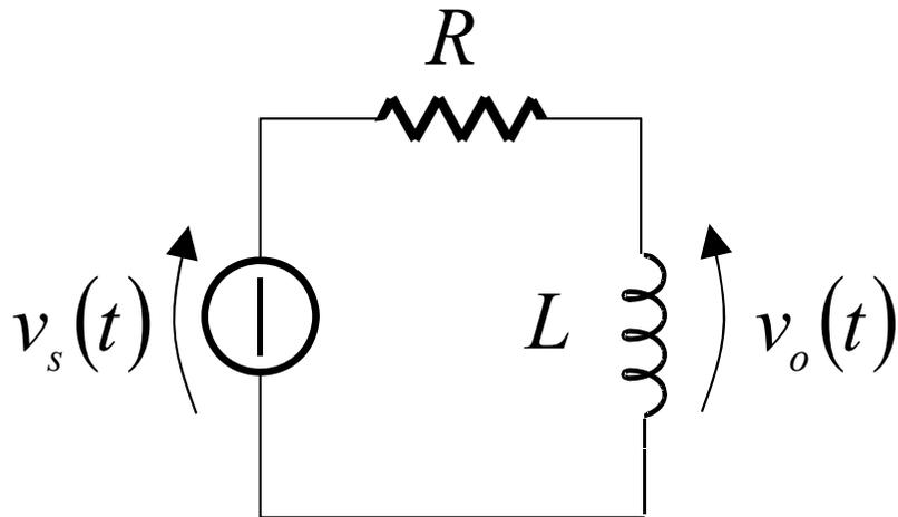
Ottenere la funzione  $V_o/V_s$  del circuito RL, assumendo  $v_s = V_m \cos \omega t$ .
