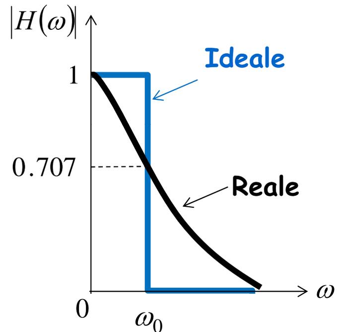
Un **filtro passa-basso** è progettato per lasciar passare soltanto le frequenze da 0 (segnale stazionario) fino alla frequenza di taglio  $\omega_0$
