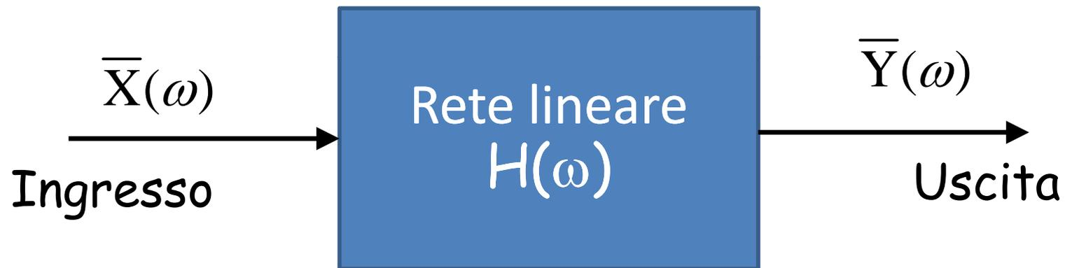
$$\dot{H}(\omega) = \frac{\bar{Y}(\omega)}{\bar{X}(\omega)} = |H(\omega)| \angle \phi$$
