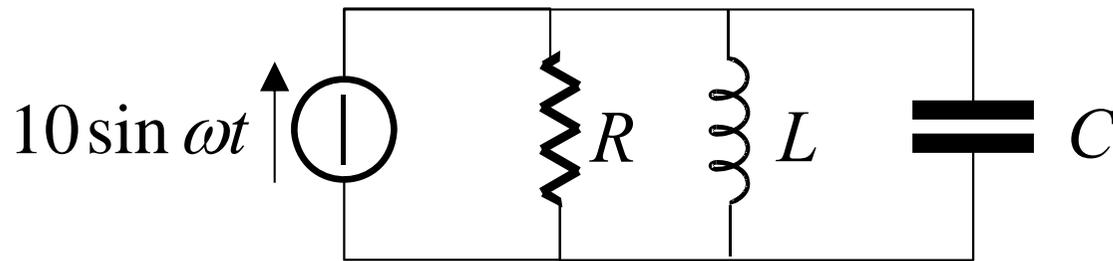
$$R=8\text{k}\Omega; L=0.2\text{mH}; C=8\mu\text{F}$$
