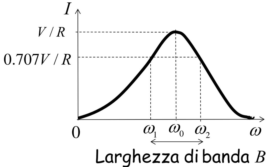
Le pulsazioni di metà potenza (**pulsazioni di taglio**)  $\omega_1$  e  $\omega_2$  sono le pulsazioni in corrispondenza delle quali la potenza dissipata è metà del valore massimo
