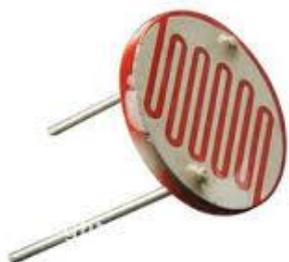
Una fotoresistenza è un componente elettronico la cui resistenza è inversamente proporzionale alla quantità di luce che lo colpisce. Si comporta come un normale resistore, ma il suo valore in Ohm diminuisce mano a mano che aumenta l'intensità della luce che lo colpisce.
