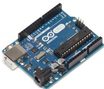
Arduino è una piattaforma hardware low-cost programmabile, con cui è possibile creare circuiti di ogni tipo per molte applicazioni. Si basa su un Microcontrollore della ATMEL, l'ATMega 328; all'interno di questo componente viene salvato il programma scritto dall'utente e tutta la configurazione di base che permette ad Arduino di funzionare correttamente. Il tutto può essere alimentato dal pc attraverso il cavo USB, tramite
