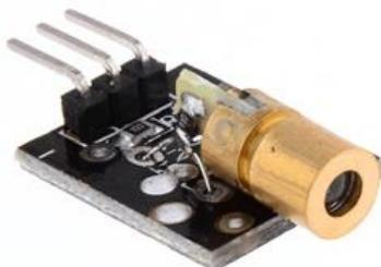
Un laser è un dispositivo in grado di emettere un fascio di luce coerente. E' composto essenzialmente da 3 parti: il mezzo attivo (gas, cristallo, liquido) che emette la luce, il sistema di pompaggio che fornisce energia al mezzo attivo e la cavità ottica o risonante che è una trappola per la luce.
