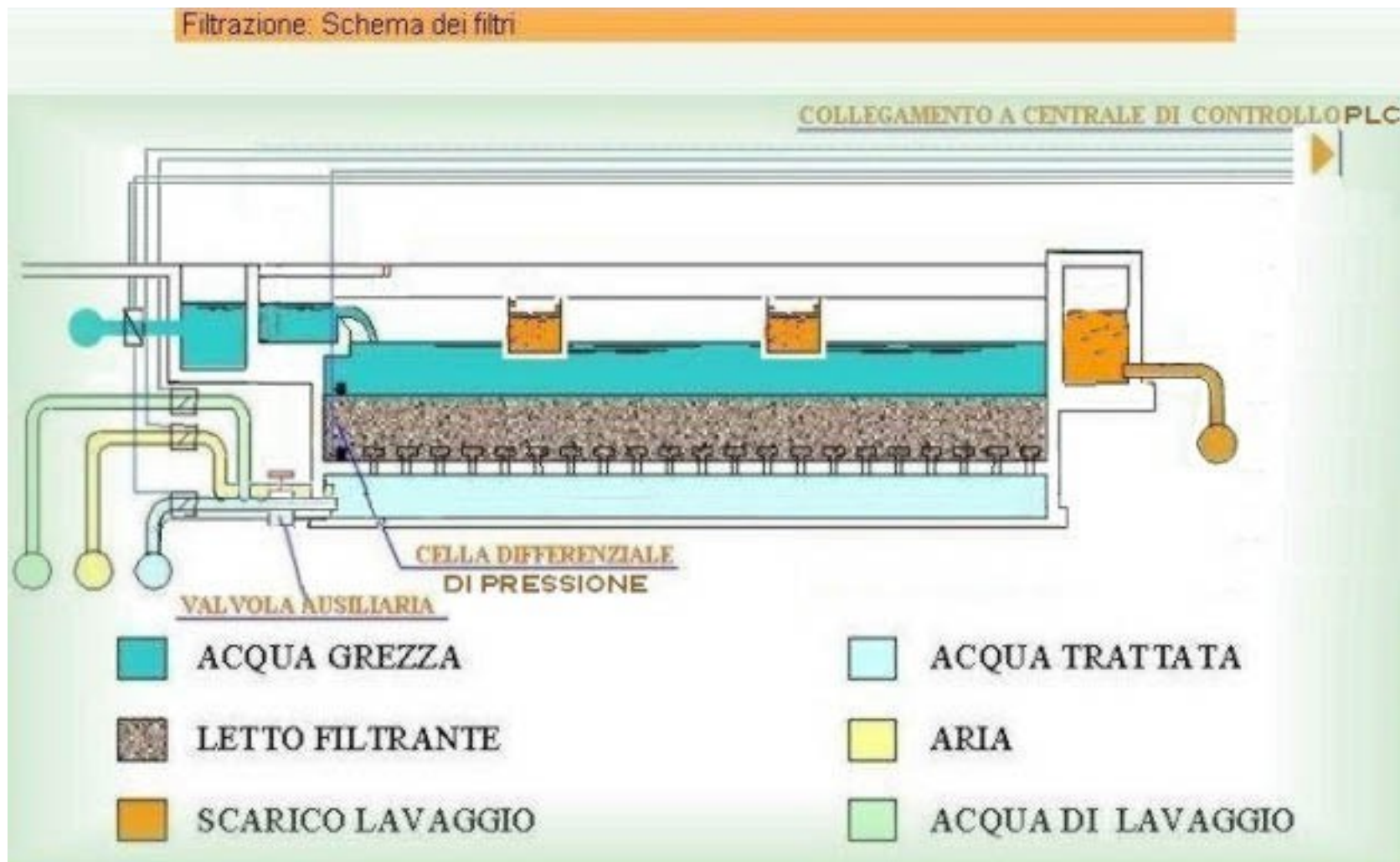
Filtrazione con filtri a sabbia
