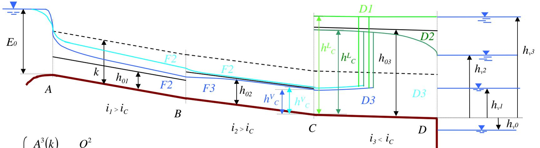
$$\begin{cases} \frac{A^3(k)}{B(k)} = \alpha \frac{Q^2}{g} \\ E_0 = k + \alpha \frac{Q^2}{2gA(k)^2} \end{cases} \Rightarrow Q, k \quad \text{Profilo risultante: } F2 + F2 \text{ (o } F3) + \text{ris.} + D1 \text{ (o } D2)$$
