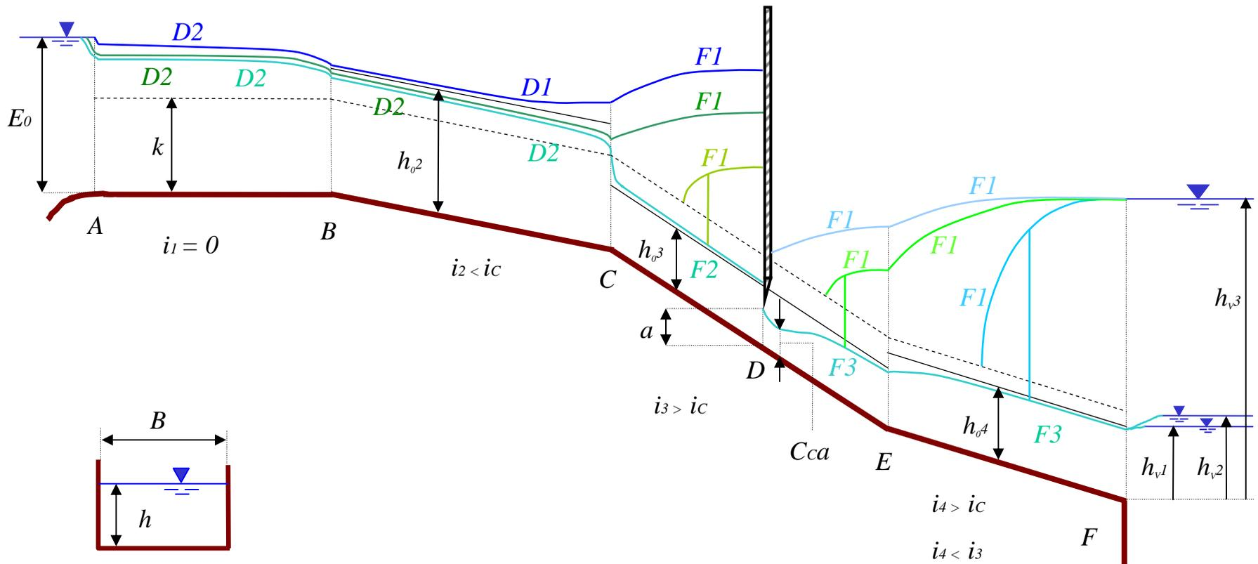
**Profili passanti per  $k$  in  $C$ :**  $D2 + D2 + F2 + \text{ris.} + F1 + F3 + F3$   $D2 + D2 + F2 + \text{ris.} + F1 + F3 + F3 + \text{ris.} + F1$
