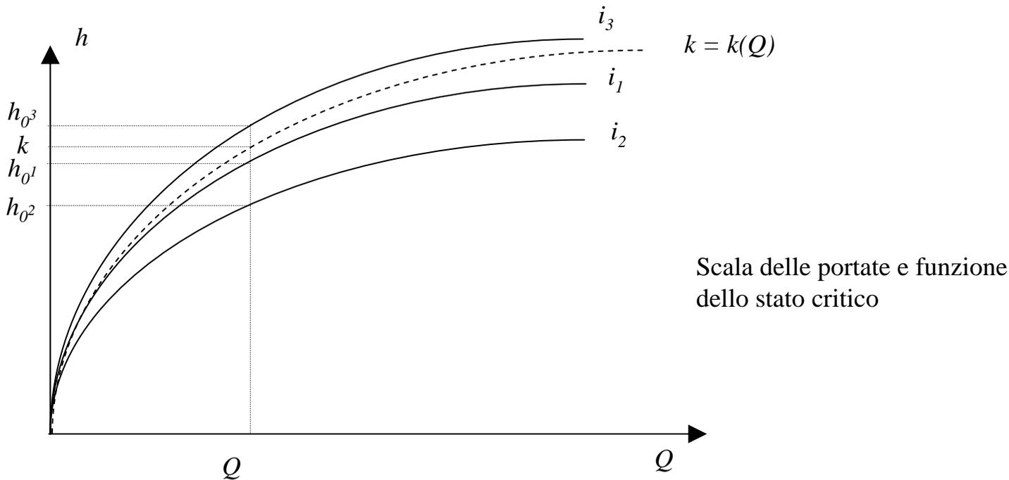
Nota dette grandezze, è possibile tracciare un profilo di corrente veloce di tipo *F3* nell'alveo a pendenza  $i_1$ , un altro profilo di corrente veloce di tipo *F2* (o *F3*) nell'alveo a pendenza  $i_2$ , ed infine un ulteriore profilo, ancora di corrente veloce, di tipo *D3*, nell'alveo a pendenza  $i_3$ .
