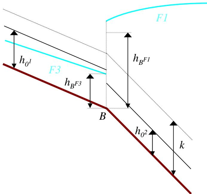
A questo punto, se tracciando – con calcolo alle differenze finite - il profilo  $FI$  nel tratto  $AB$ , esso incontrerà lo stato critico  $\Rightarrow$  nel tratto  $AB$ , a valle del passaggio per  $k$  del profilo  $FI$ , ci sarà un risalto tra la corrente veloce  $F3$  e quella lenta  $FI$ , nella sezione ove le spinte totali di dette correnti si eguaglieranno.
