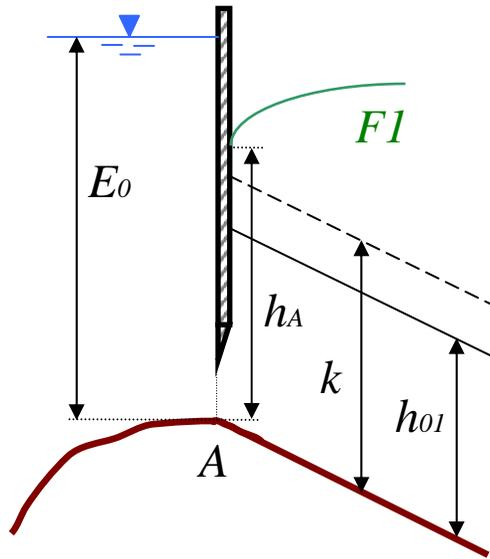
Vale la pena osservare che è anche possibile ipotizzare un certo carico  $h_{st}'$  sullo stramazzo per ricavare, sempre a mezzo dell'equazione di efflusso, la portata  $Q'$  necessaria per poter procedere, verso monte, all'integrazione per differenze finite del profilo di corrente lenta.
