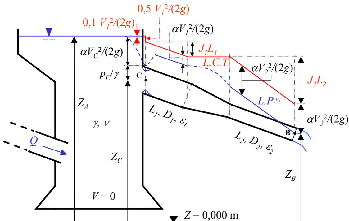
$$\left[ \begin{array}{ll} Z_A = Z_B + \alpha V_2^2/(2g) + 0,5 V_1^2/(2g) + J_1 L_1 + J_2 L_2 = 11,725 \text{ m} & p_C/\gamma = -0,715 \text{ m (tubi lisci)} \\ Z_A = Z_B + \alpha V_2^2/(2g) + 0,5 V_1^2/(2g) + J_1 L_1 + J_2 L_2 = 12,614 \text{ m} & p_C/\gamma = 0,174 \text{ m (tubi scabri)} \end{array} \right]$$
