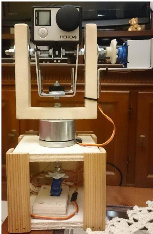
Il progetto è stato realizzato con la piattaforma hardware Arduino. Il suo scopo è quello di far cambiare la visuale ad una action-cam (in questo caso una GoPro Hero 4) lungo l'asse X e Y. I due moti sono garantiti da due servomotori (coprono un angolo di 180°), collegati nei pin digitali della scheda. I comandi sono impartiti da 4 pulsanti, anch'essi collegati ai pin digitali della scheda.
