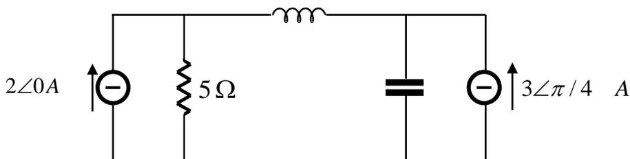
Trovare il circuito equivalente di Thévenin del circuito in figura ai morsetti (A,B)
