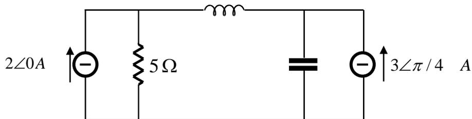
Trovare il circuito equivalente di Thévenin del circuito in figura rispetto alla coppia di terminali (1,2)
