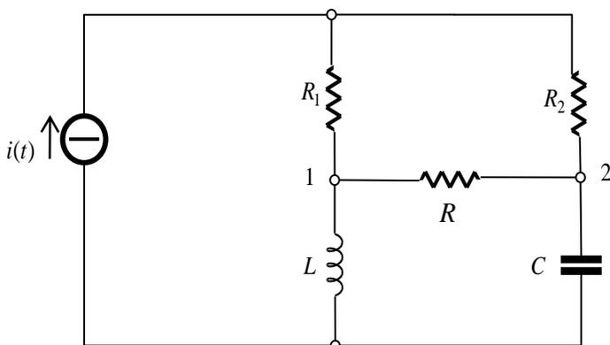
Il circuito è in regime sinusoidale. Determinare il circuito equivalente di Thevenin, visto dai morsetti 1-2 del resistore R sapendo che:
