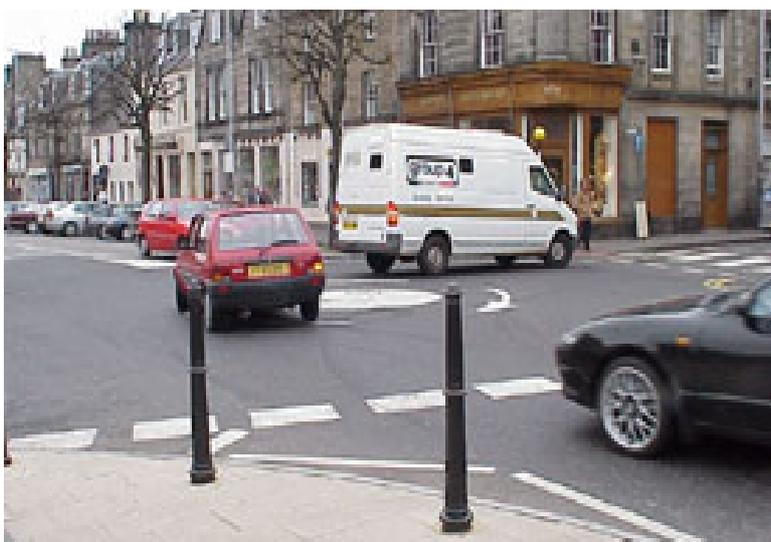
Intersezione regolata mediante mini rotatoria disegnata sulla pavimentazione stradale in Inghilterra.
